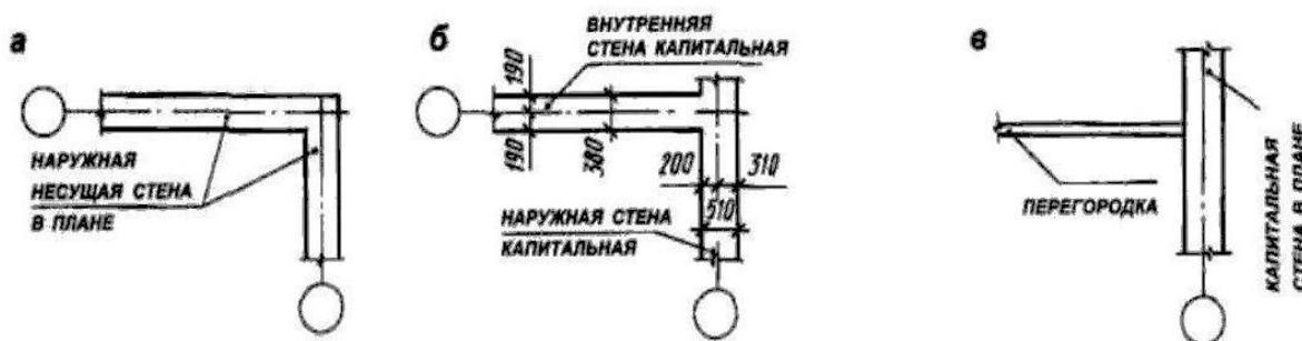
Рис. 1 Схемы привязки стен и перегородок к координационным осям.
