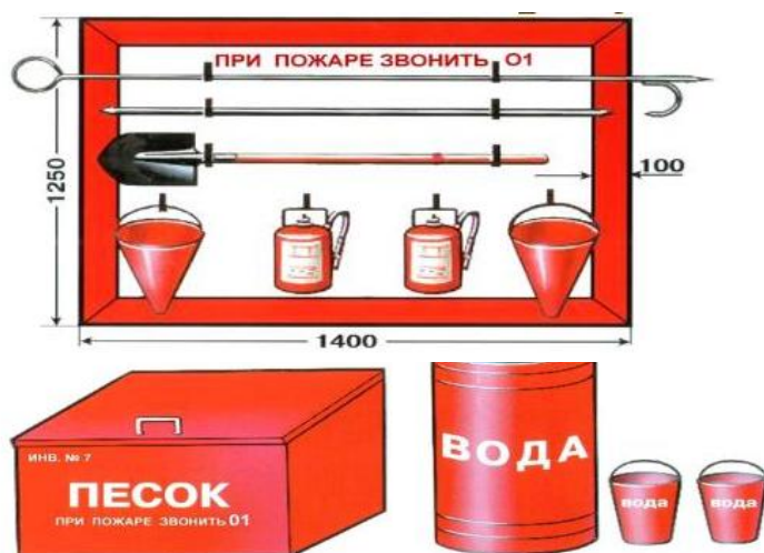
Рисунок 6 - Пожарный щит первичных средств пожаротушения
