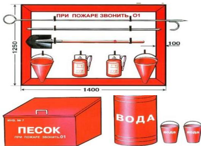
Рисунок 6 - Пожарный щит первичных средств пожаротушения
