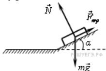
На него действуют три силы: сила тяжести  $m\vec{g}$ , сила реакции опоры  $\vec{N}$ , и сила трения  $\vec{F}_{tp}$ . Чему равен модуль равнодействующей сил  $\vec{F}_{tri}$   $m\vec{g}$ ?
