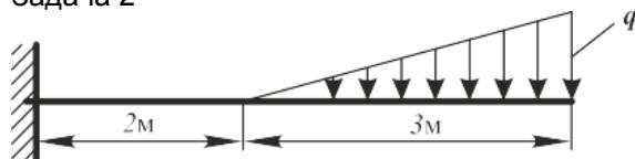
На горизонтальную невесомую балку, жёстко заделанную одним концом, действует линейно распределённая нагрузка. Максимальная интенсивность нагрузки равна  $q = 100 \text{ Н/м}$ . Определить момент заделки ... Нм
