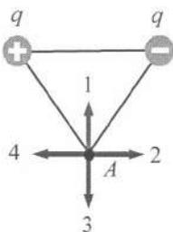
Вектор напряженности результирующего электростатического поля этих зарядов в точке A под номером ....
