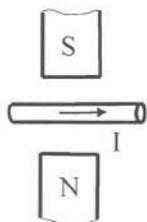
Сила Ампера, действующая на проводник с током, направлена ...
