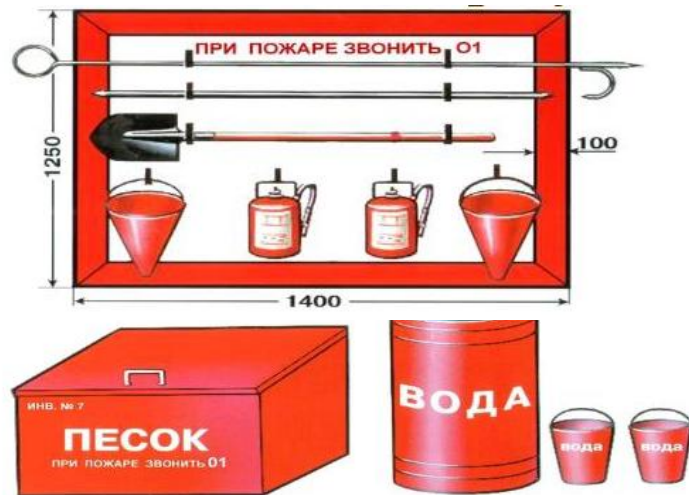
Рисунок 6 - Пожарный щит первичных средств пожаротушения
