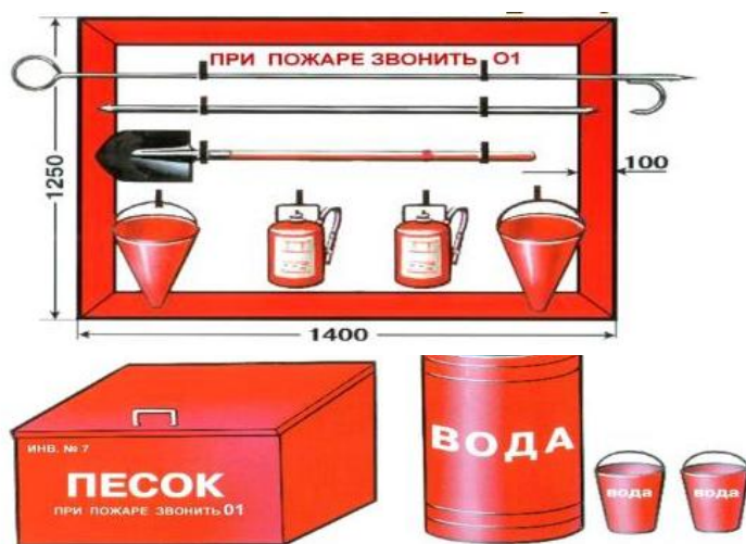
Рисунок 6 - Пожарный щит первичных средств пожаротушения
