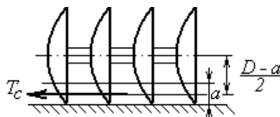
Рис. 5. К определению опрокидывающего момента, действующего на секцию
