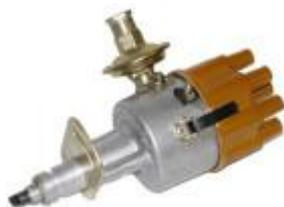
Прерыватель и распределитель конструктивно объединены в одном корпусе и приводятся в действие от коленчатого вала двигателя. Данное
