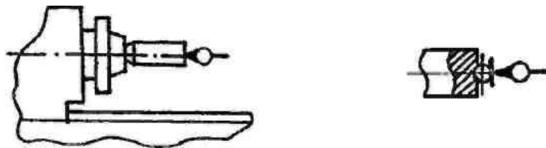
Рисунок 4 - Схема установки индикатора для проверки осевого биения шпинделя
